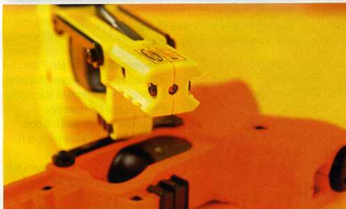
Vorderansicht des ungeladenen Behördenmodelles mit der Austrittsöffnung des Ziellasers zwischen Schiene und Griffstückoberseite.
