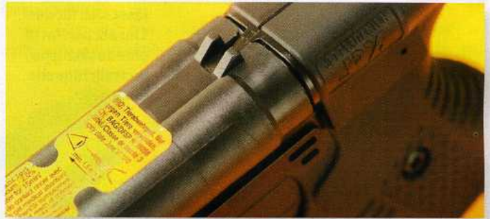
U-Kimme und Blockkorn befinden sich auf der Oberseite des zweischüssigen Wechselmagazins.
